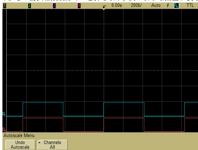
図7 デジタル・チャンネル0と1のオートスケール (MSOモデルのみ)
